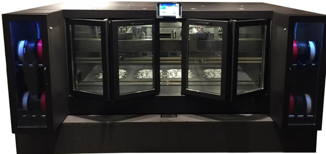
Machine met 4 Koppen, elke kop heeft hier 50 verschillende parts geprint
